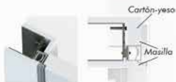
INSTALACIÓN EN CARTÓN-YESO
